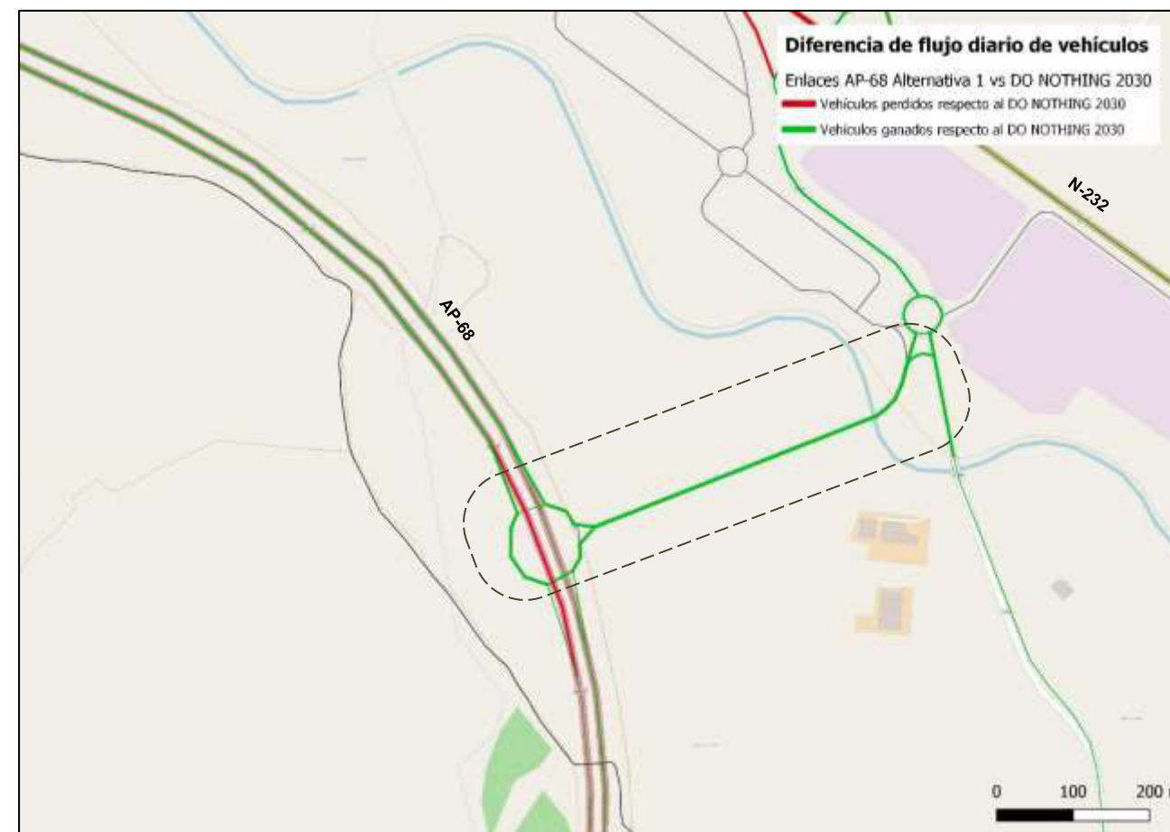
Ilustración 34 - Diferencia de flujo entre el escenario DN 2030 y la Alternativa 1. Enlace de Aldeanueva.
